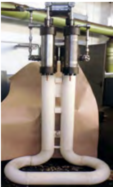
Рис. 6. Экспериментальный образец гидроударного компрессора КГУ-1
